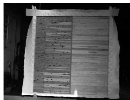
防火壁の試験体
