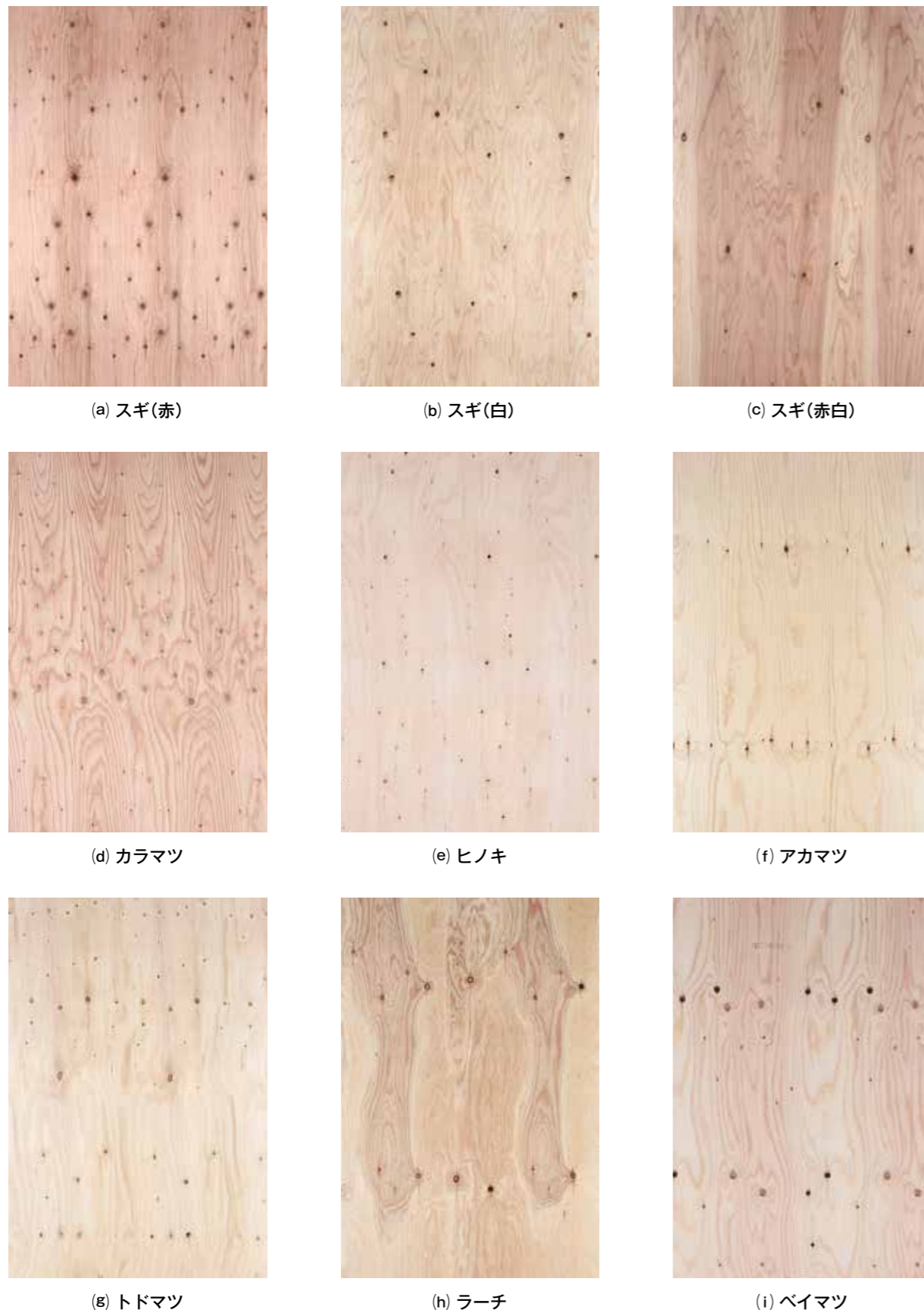
図1-3 構造用合板の板面の例 (Cグレードの板面)
