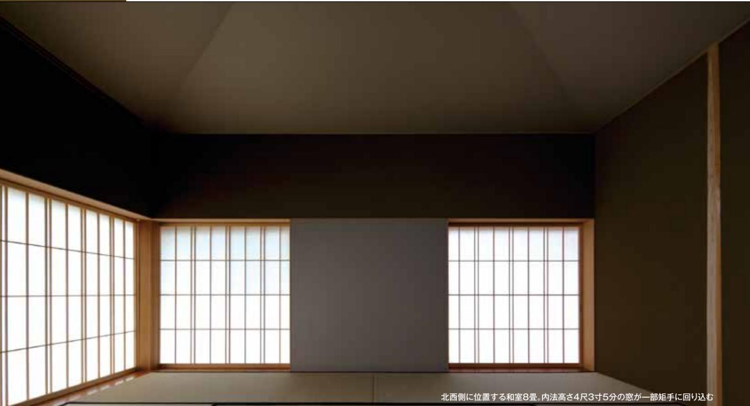
北西側に位置する和室8畳。内法高さ4尺3寸5分の窓が一部矩手に回り込む
