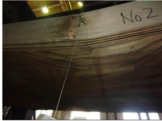
図 7. 試験体 No.2 の破壊時の様子 (続き)
