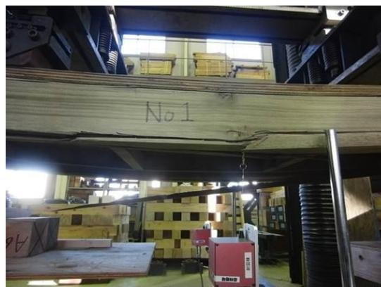
図 5. 試験体 No.1 の破壊時の様子 (続き)
