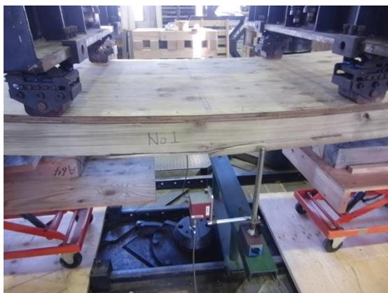
図 4. 試験体 No.1 の破壊時の様子
