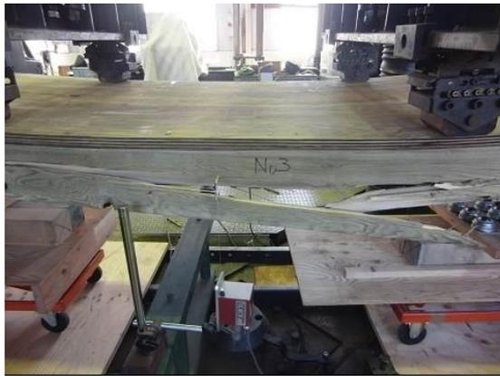
図 8. 試験体 No.3 の破壊時の様子
