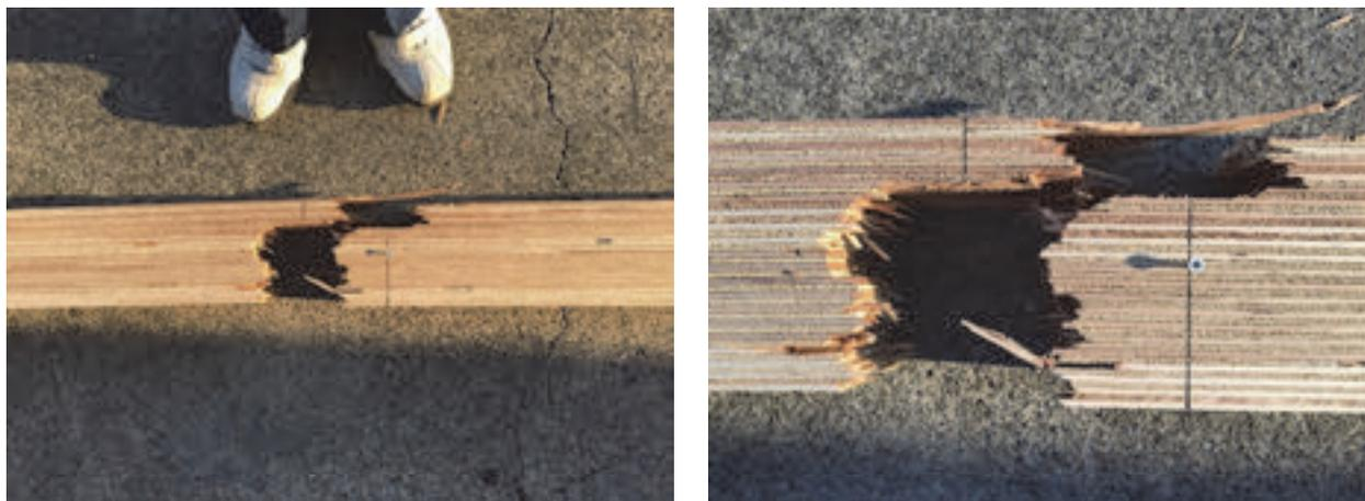
図 4.7 代表的な破壊の例（加力点間での破壊）
