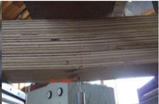
写真2 曲げ破壊
