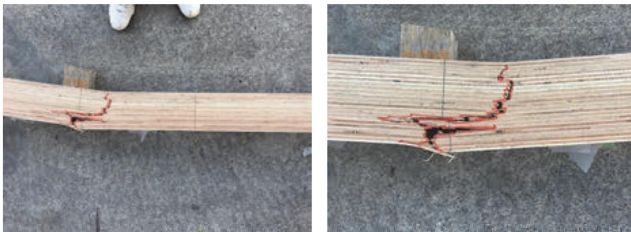
図 4.8 代表的な破壊の例（加力点直下での破壊）
