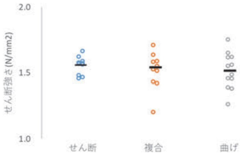
図 5.5 幅 40mm タイプの破壊要因別のせん断強さ
