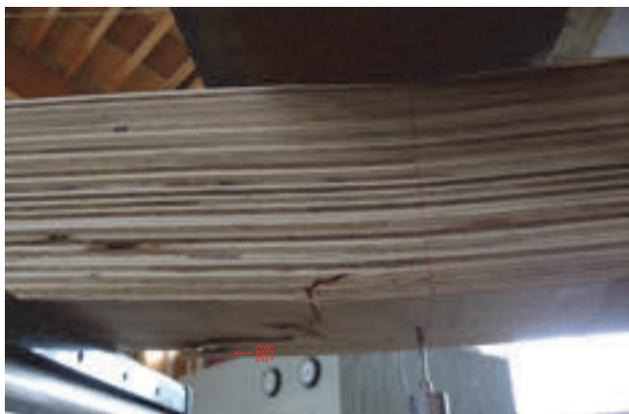
写真5 節を起点とした曲げ破壊
