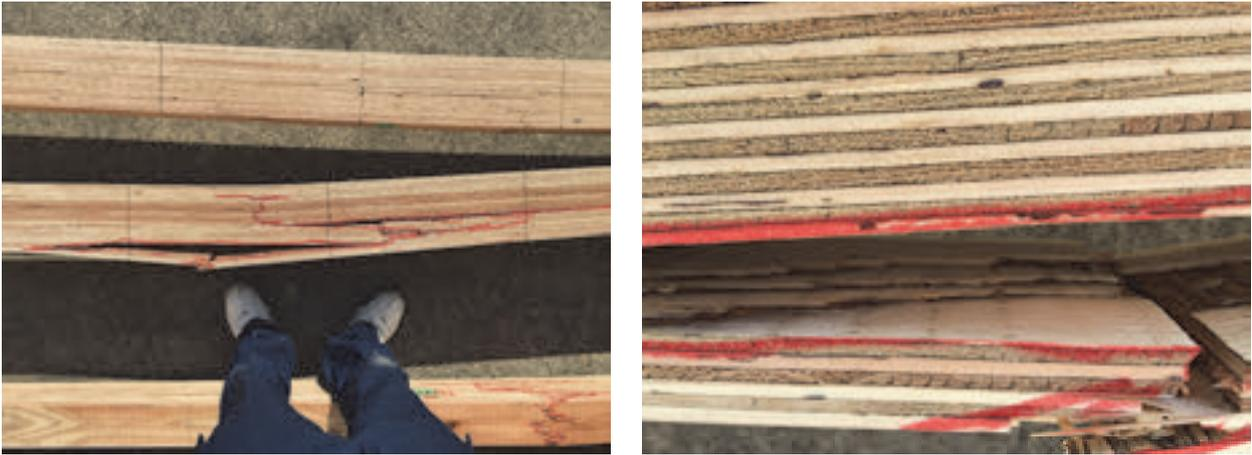
図 4.10 代表的な破壊の例（２段階で破壊が生じた例）
