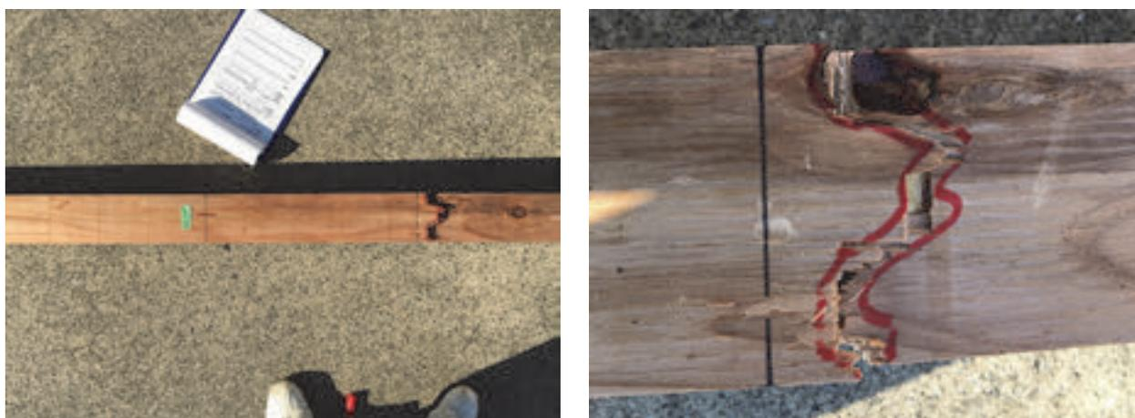
図 4.9 代表的な破壊の例（下面単板の節が起点となった破壊）
