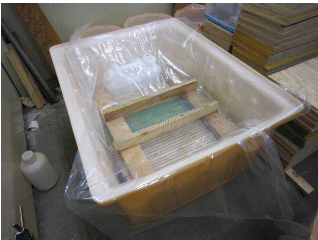
写真 4. 曲げ強度試験体浸漬処理風景
