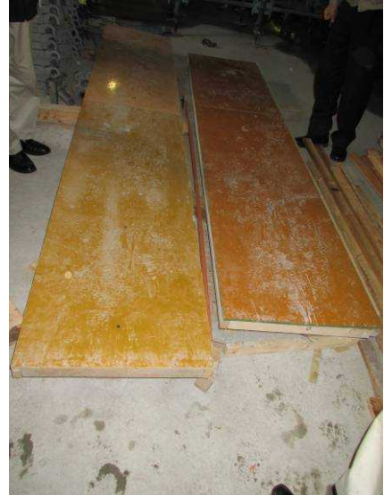
打設後の型枠合板表面 左:南洋材、右:地域材
