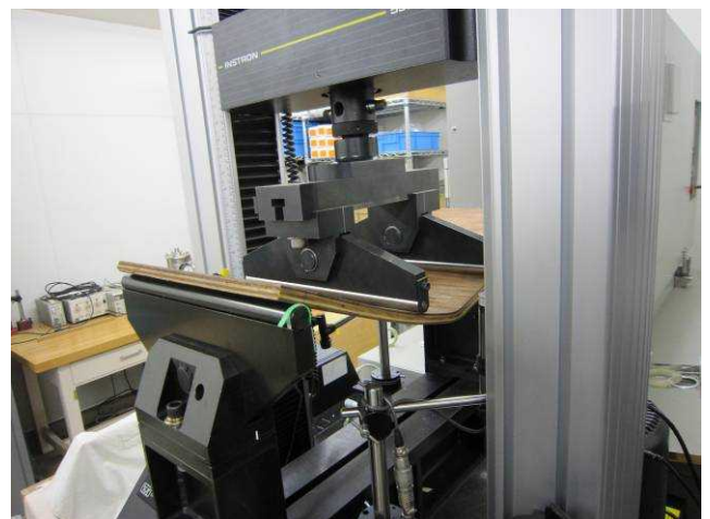
写真 2. 曲げ強度試験風景
