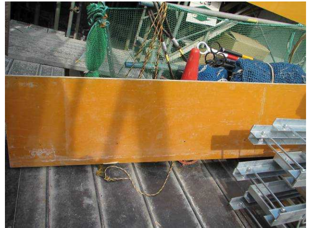
打設後の型枠パネル表面
