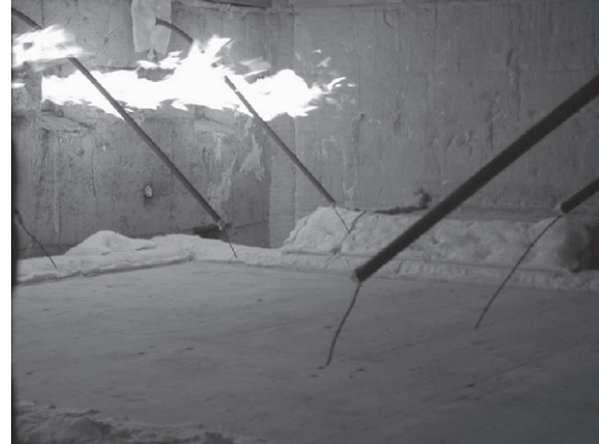
加熱試験開始直後の試験体
