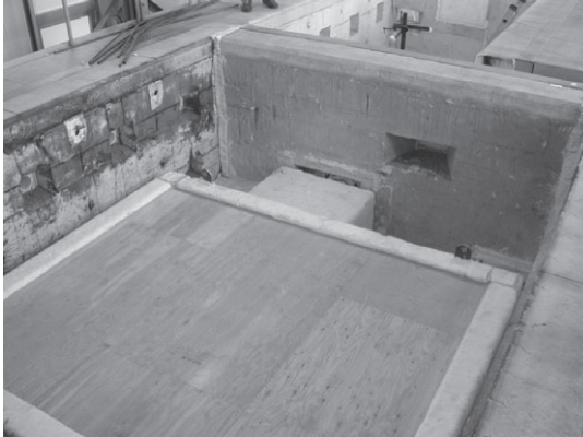
準耐火性能評価試験の試験体
