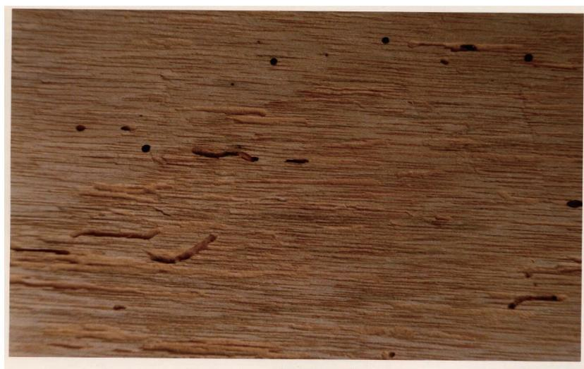
写真4 合板の被害；フローリングの裏側
