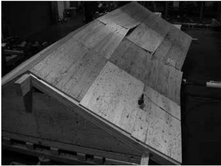
図 30. 合板の圧縮座屈 (川の字仕様)
