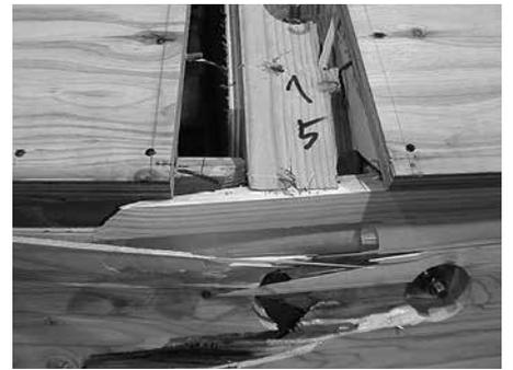
図 29. 桁の引張破壊
