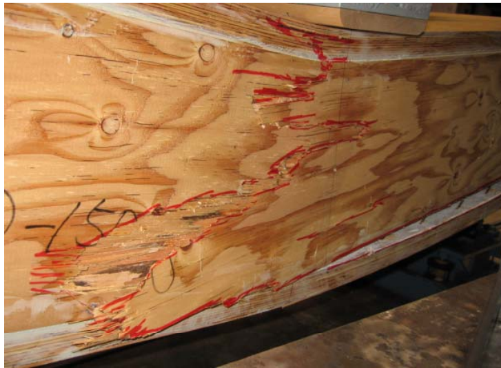
LB2-6000 ウェブの曲げ破壊(左)
