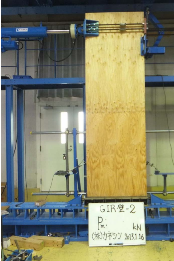
壁仕様 LVL 120E 1級 厚150×幅1000×高3000 mm
