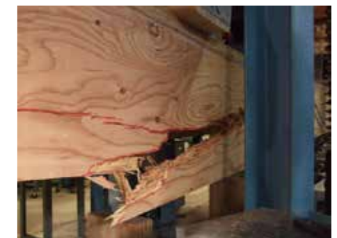
ウェブの曲げ破壊（試験体 1）
