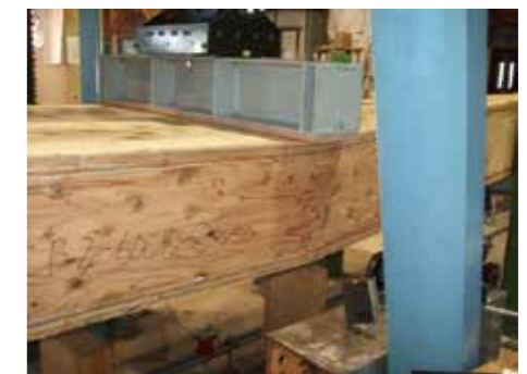
ウェブの曲げ破壊（試験体 2）
