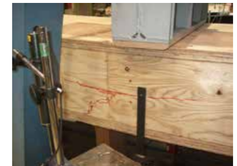
ウェブの曲げ破壊（試験体 3）
