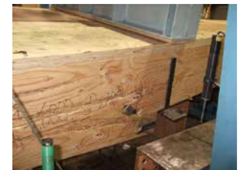
ウェブの曲げ破壊（試験体 1）
