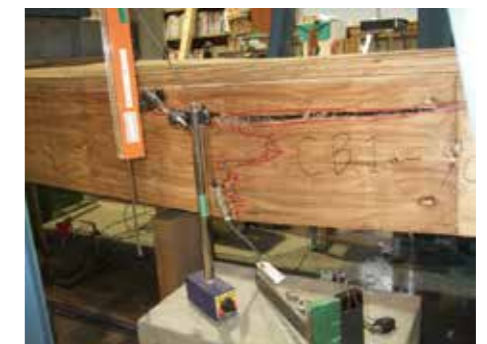
ウェブの曲げ破壊（試験体 3）
