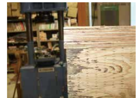
ウェブの曲げ破壊（試験体 1）
