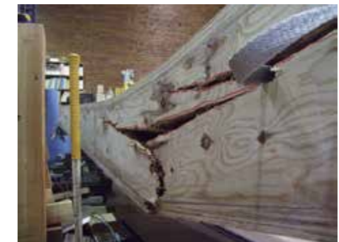
ウェブの曲げ破壊（試験体 1）
