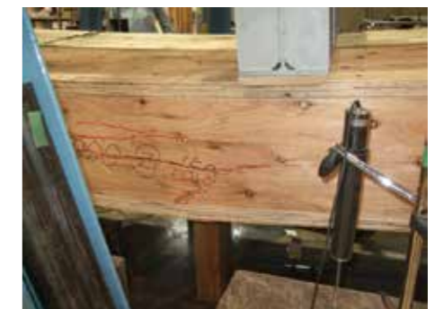
ウェブの曲げ破壊（試験体 2）
