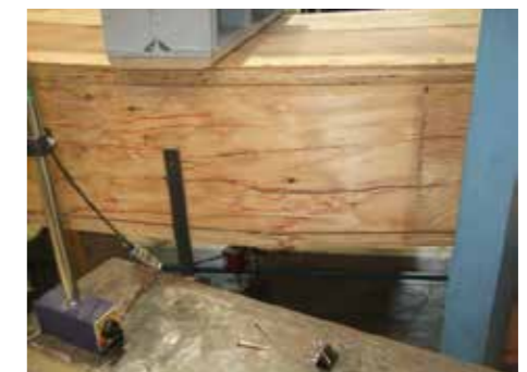
ウェブの曲げ破壊（試験体 3）
