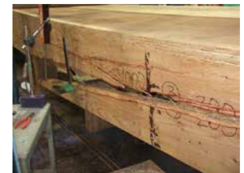
ウェブの曲げ破壊（試験体 3）
