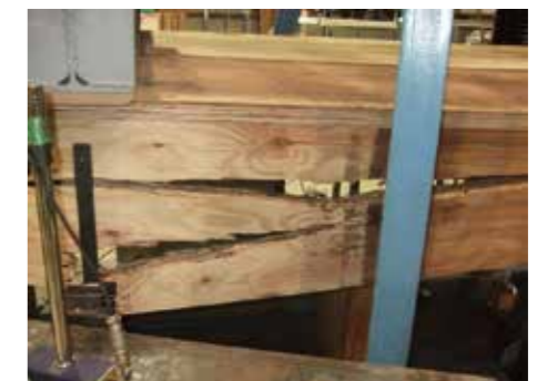
ウェブの曲げ破壊（試験体 2）
