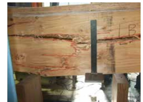
ウェブの曲げ破壊 (試験体 2)
