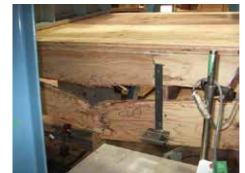
ウェブの曲げ破壊（試験体 1）
