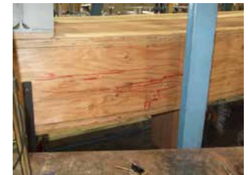
ウェブの曲げ破壊（試験体 1）
