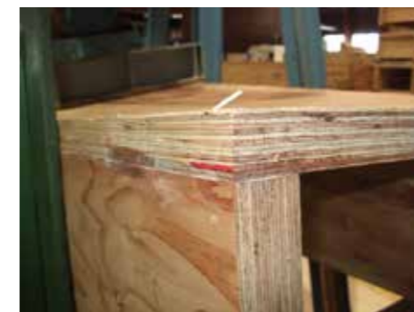
部材間ずれの発生なし（試験体 3）
