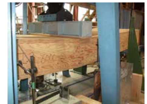
ウェブの曲げ破壊（試験体 2）
