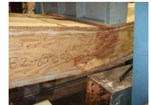
ウェブの曲げ破壊（試験体 1）
